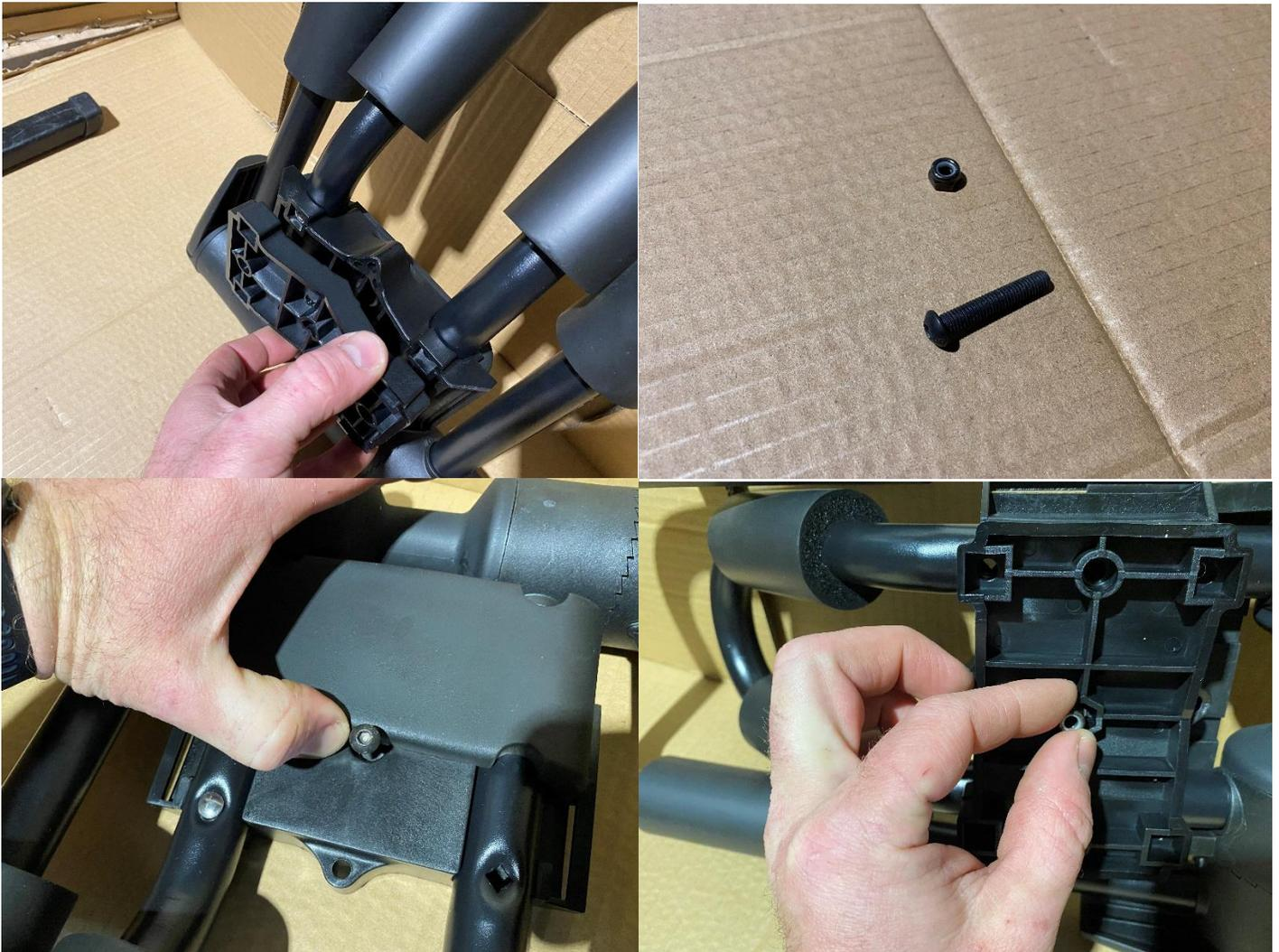
7- Insérer 2 vis de 100mm par le dessus du support,
