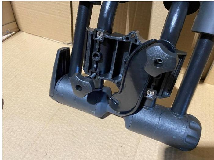
4- Déposer les supports sur les barres de toit, glisser la partie ouverte de la plaque sur la deuxième vis et serrer les papillons. Assurez-vous que les supports soient bien perpendiculaires avec les barres de toit.
