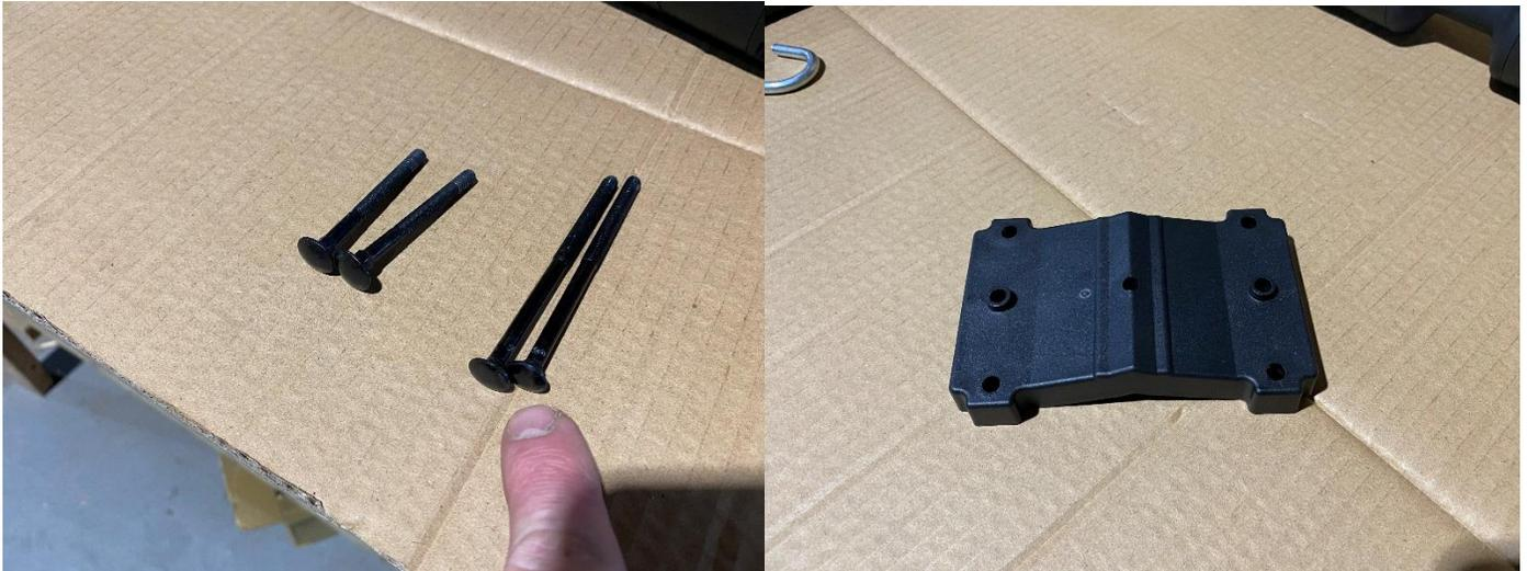
6- Fixer la plaquette surélévatrice, sous le support à kayak, à l'aide de la petite vis de 40mm et du boulon autobloquant. Il faut repousser le caoutchouc du support, pour avoir accès au trou central, pour insérer la vis.
